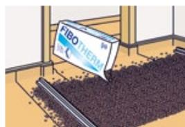
Die Ränder mit Dämmmaterial abkoppeln, Schüttung ausbringen und auf die gewünschte Höhe abziehen.
