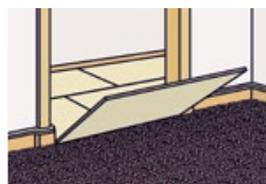
Zur höheren Trittschalldämmung wird der Blähton danach mit Holzweichfaserplatten abgedeckt.
