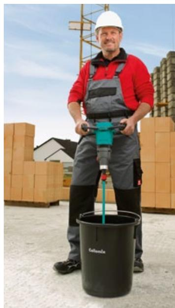
*Professionelle Rührgeräte besitzen beidseitig angebrachte Haltegriffe sowie standfeste, kraftvolle Motoren, die die Drehzahl beim Mischen konstant halten. Sie ermöglichen ein ergonomisch korrektes Arbeiten mit gerade durchgedrücktem Rücken.*
