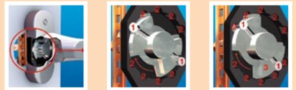
Beim Drehen des Secustik®-Fenstergriffs rasten die federgelagerten Sicherungsbolzen (1) in spezielle Aussparungen im Gehäuse (2) ein. Die Sicherungsbolzen werden vom Kupplungselement (3) zu den Aussparungen (2) mitgenommen und rasten dort ein.
