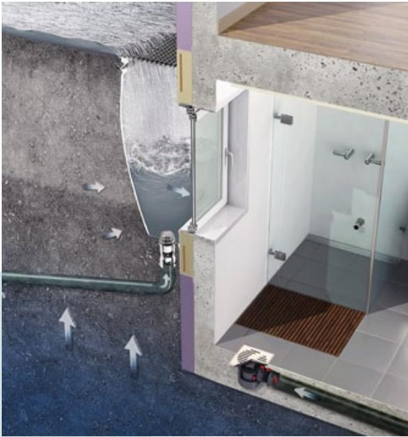
Das ACO Kellerschutz-System besteht aus druckwasserdichtem Lichtschacht mit Rückstauverschluss, dem wärmegeprägten ACO Therm® Block und einem hochwasserdichten Fenster.
