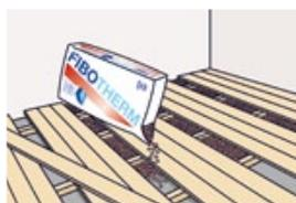
Zur Wärme- und Schalldämmung wird Blähton in die Hohlräume zwischen den Balken geschüttet.
