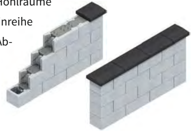
Der Aufbau einer Schalungssteinmauer
